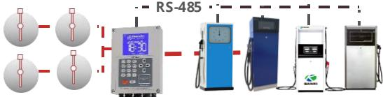
Контроллер подключается к имеющемуся оборудованию через интерфейс RS-485 или через прямое соединение.
